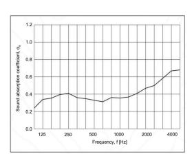
Montaje: Los paneles se colocaron planos sobre el suelo de cemento en la sala de prueba de reverberación, marco cerrado en los bordes
